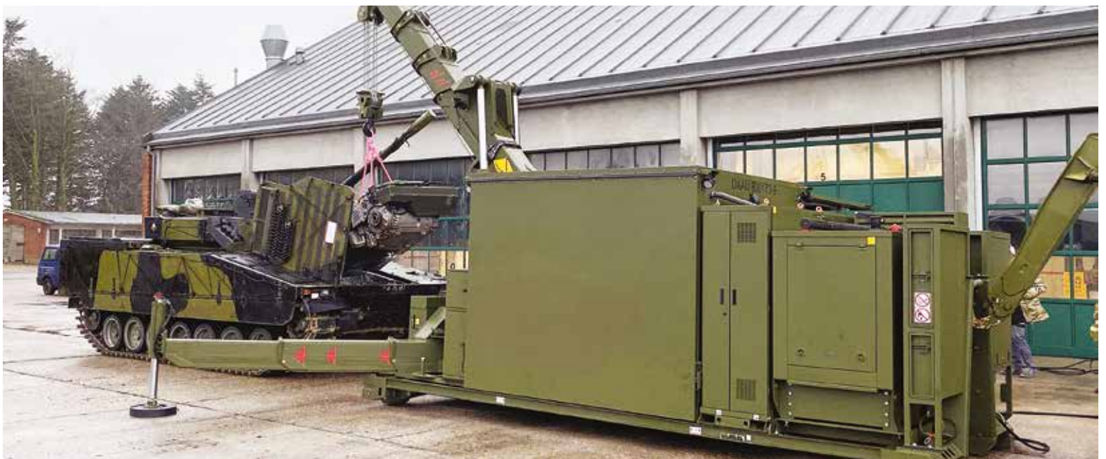
Demonstrasjon av motorservice på CV90. Foto Glaucus
