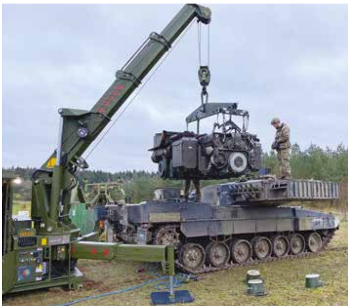
Leopard stridsvognsreparasjon i felt. Foto Glaucus
